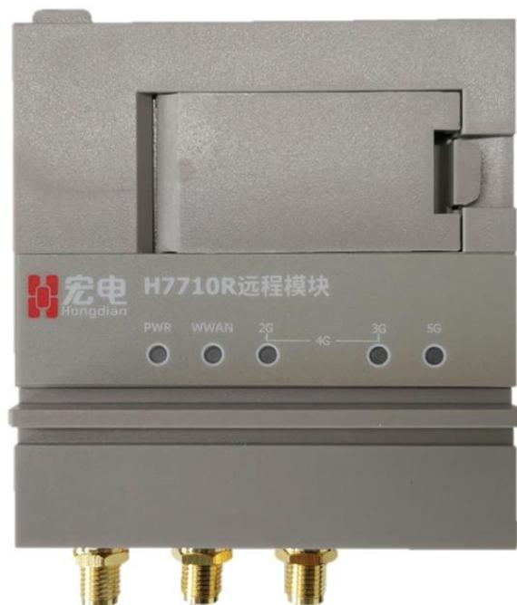
图 4-1 H7710R 远程通信模块实物图（5G 版本）
