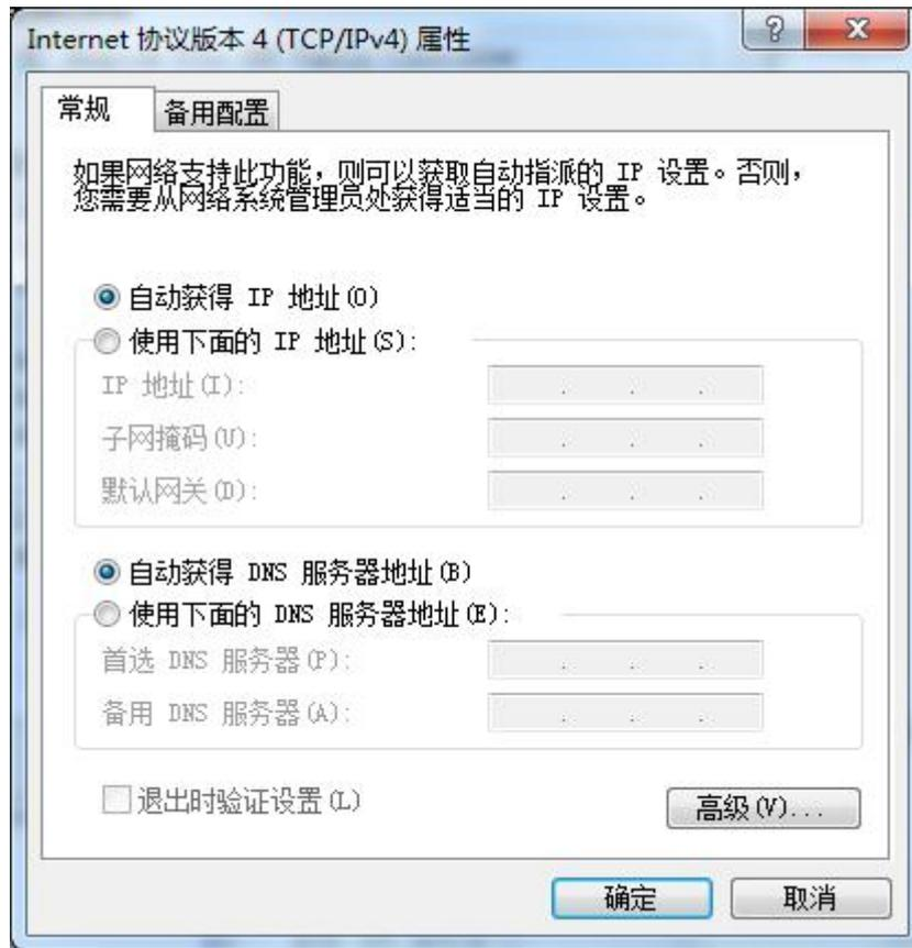
步骤 4 如果 Internet 协议 (TCP/IP) 属性如图 4-8 所示, 则无需改动; 如果 Internet 协议 (TCP/IP) 属性不是图 4-10 所示, 则在“常规”中选择“自动获得 IP 地址”。
