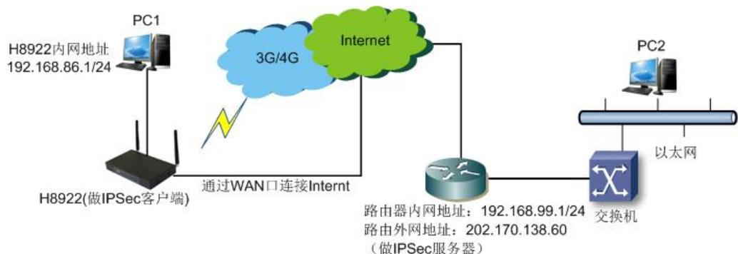
PC1 通过 H8922、H8922S 的 VPN 功能与公司的路由器建立 IPSec 的链接，使用隧道模式通信。H8922、H8922S 侧的局域网地址为 192.168.86.1/24，公司路由器侧的局域网地址为 192.168.99.1/24；通过建立的 IPSec 连接，两个局域网能够安全的通信。
