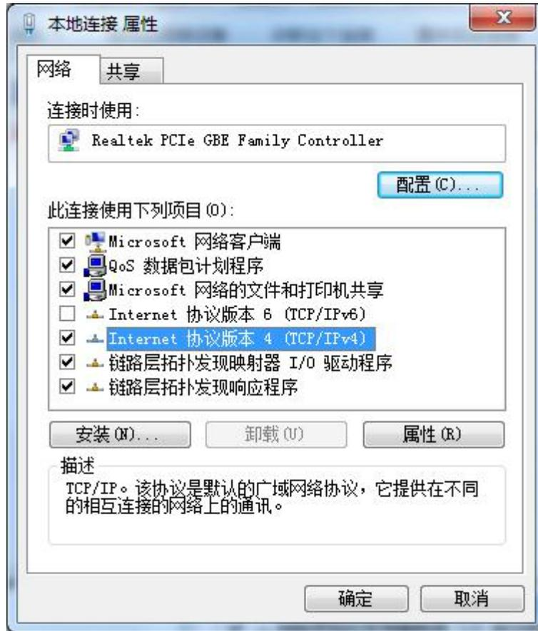
步骤 3 在“此连接使用下列项目(O):”中，选择“Internet 协议 (TCP/IP)”并双击进入“Internet (TCP/IP) 属性”窗口，如图 4-10 所示。
