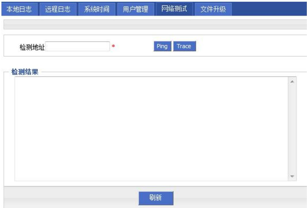
**步骤 3** 在“检测地址”框中输入要测试 IP 地址或域名，单击“Ping”，测试路由器与目的地址的连通性。
