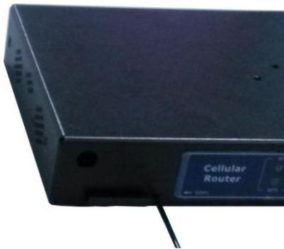
**步骤 2** 将 SIM 卡金属面朝上，插入到卡座，缺角端朝外侧。然后将卡座按推入卡槽。如图 3-2 所示。
