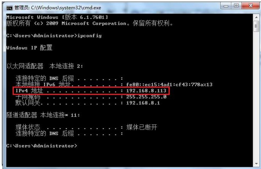
图 4-13 DHCP 自动获取 IP 方式“ipconfig”执行结果
