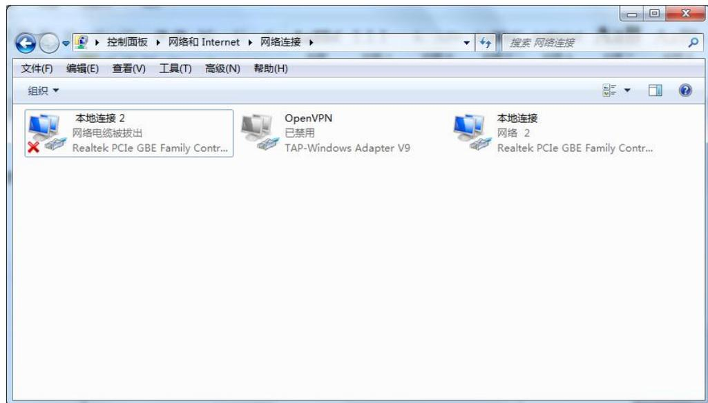
**步骤 2** 右键单击“本地连接 2”并在弹出的菜单中单击“属性”，打开“本地连接 2 窗口”，如图 4-9 所示。
